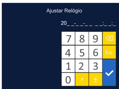
Na função *Ajustar Relógio*, é possível configurar a data e hora no formato AAAA/MM/DD HH:MM:SS em seu MRG3030. Utilize o teclado para inserir os dados corretamente e toque em confirmar. Você pode visualizar essas informações ao acessar o Menu Guia Rápido.
