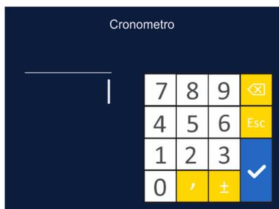
Na função *Cronômetro*, é possível configurar um tempo, em segundos, desta forma, seu MRG3030 irá operar automaticamente até a contagem zerar.
