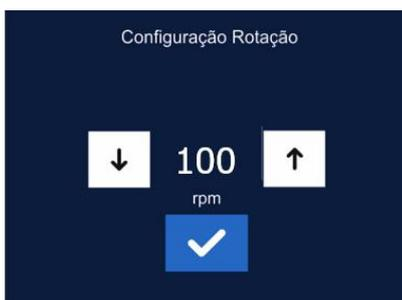
Na função *Ajustar Rotação*, é possível configurar a velocidade, em rotações por minuto, na qual seu MRG3030 irá operar. Utilize as setas para diminuir ou aumentar a velocidade e selecione *Confirmar*. Seu moinho tem o ajuste de 100 a 400 r.p.m. (de 50 em 50). É indicado que a velocidade seja inversamente proporcional à viscosidade do produto trabalhado, ou seja, quanto mais viscoso, menor a velocidade.
