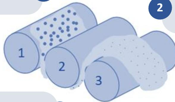
**Rolo de descarga:** responsável por retirar o material acabado, girando em alta velocidade (configurável).
