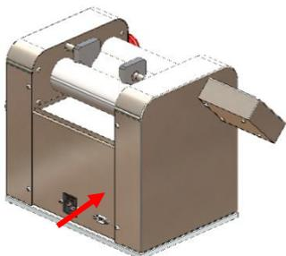
Conecte o cabo AC na tomada e acople o plug para alimentação de energia.
