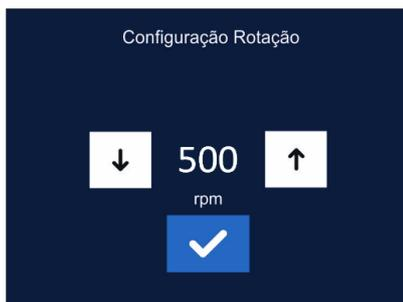
Na função *Ajustar Rotação*, é possível configurar a velocidade, em rotações por minuto, na qual seu MRG2020 irá operar. Utilize as setas para diminuir ou aumentar a velocidade e selecione *Confirmar*. Seu moinho tem o ajuste de 300 a 700 r.p.m. (de 50 em 50). É indicado que a velocidade seja inversamente proporcional à viscosidade do produto trabalhado, ou seja, quanto mais viscoso, menor a velocidade.
