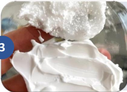
Com o auxílio de uma espátula, alimente o eixo traseiro com a pré-mistura. O produto nanoestruturado será dispensado e coletado pelo raspador. Repita o processo, caso necessário.
