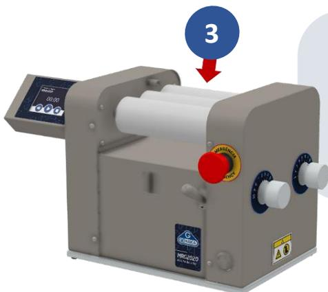
Coloque os knobs laterais nas posições 10:10 e lave as guias e o raspador à parte. Toque na opção de limpeza do display. Com o auxílio de um pano ou papel umedecido, realize a limpeza rolo a rolo, posicionando o tecido sobre os rolos em movimento e pressionando-o levemente (item 3).
