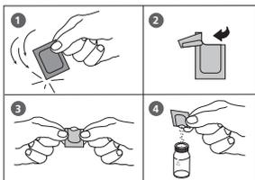
5. Adicionar o conteúdo de **duas saquetas de pó de VARIO Chlorine TOTAL-DPD/F10** diretamente do blister à amostra de 5 ml.
