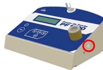
3. Com o auxílio das setas, ajuste a temperatura do equipamento para que fique igual a temperatura do termômetro calibrado e tecele SIM.
