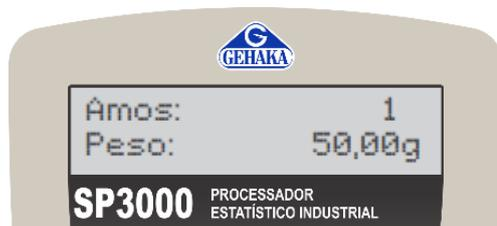
Inicie a pesagem das amostras (a quantidade de amostras é definida na etapa de configuração do produto). Após finalizar, será emitido o relatório de acordo com as configurações.
