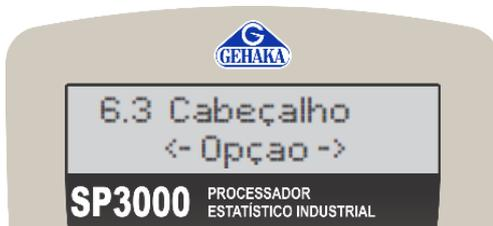
Essa opção é indicada para o operador alterar o nome que será impresso no topo de todos os relatórios. Selecione a tecla ENTER para iniciar a alteração.
