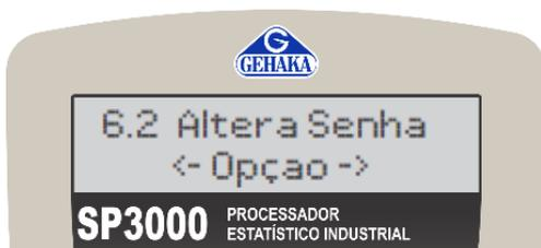
Essa opção é indicada para o operador alterar a senha de configuração do equipamento. Para iniciar, selecione a tecla ENTER.
