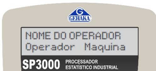
Informe ao equipamento o nome do operador que realizará todo o processo de pesagem e selecione ENTER.
