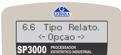
Essa opção é indicada para o operador alterar o tipo de relatório do equipamento. Selecione a tecla ENTER para iniciar a alteração.
