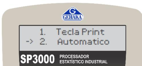
O modo "Automático" configura a captação dos dados automaticamente a partir da estabilização da balança no momento da pesagem. Para selecionar esse modo, utilize as setas e pressione a tecla ENTER quando a seta do display estiver ao seu lado.
