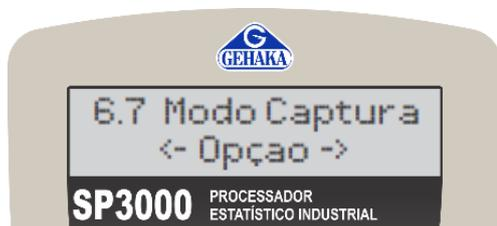
Essa opção é indicada para o operador alterar o modo de capturado equipamento. Selecione a tecla ENTER para iniciar a alteração.
