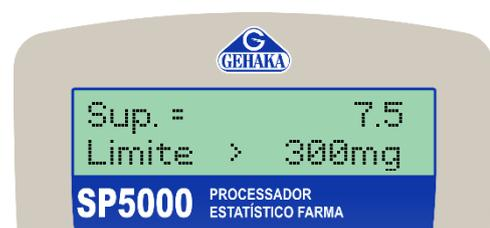
Digite o valor com o auxílio do teclado e das setas (limite máx. de 7,5%). Após escolher o limite, pressione a tecla ENTER para que o equipamento registre o novo ajuste em sua configuração.
