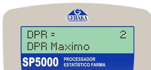
Digite o valor com o auxílio do teclado e das setas (limite máx. de 4%). Pressione a tecla ENTER para que o equipamento registre o novo ajuste em sua configuração.
