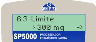
Configura o limite percentual da relação Peso Cápsula/Peso Médio para cápsulas com o peso maior que 300 mg (limite máx. 7,5%).
