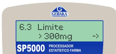
Essa opção é indicada para o operador ajustar um novo valor de percentual de limite maior que 300 mg de acordo com as especificações do processo interno. Para iniciar, selecione a tecla ENTER na opção.
