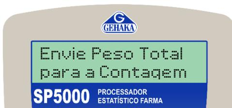
Em seguida, despeje sobre o prato da balança o total das cápsulas, tecele IMPRIME na balança para que ela envie o valor do Peso Total das cápsulas. Com esse resultado, o SP5000 gera o relatório complementar indicando o peso total e o total de cápsulas, como ilustrado abaixo.
