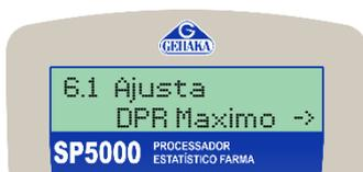
Configura o valor de Desvio Padrão Relativo máximo do processo (limite máx. 4%).
