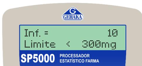
Digite o valor com o auxílio do teclado e das setas (limite máx. de 10%). Após escolher o limite, pressione a tecla ENTER para que o equipamento registre o novo ajuste em sua configuração.
