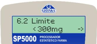
Configura o limite percentual da relação Peso Cápsula/Peso Médio para cápsulas com o peso menor que 300 mg (limite máx. 10%).
