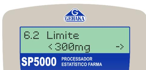
Essa opção é indicada para o operador ajustar um novo valor de percentual de limite menor que 300 mg de acordo com as especificações do processo interno. Para iniciar, selecione a tecla ENTER na opção.
