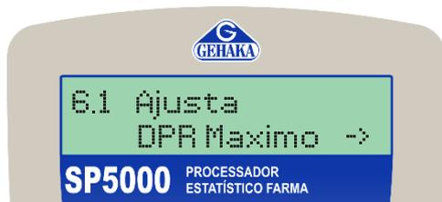
Essa opção é indicada para o operador ajustar um novo valor de Desvio Padrão Relativo Máximo do produto de acordo com as especificações do processo interno. Para iniciar, selecione a tecla ENTER na opção.
