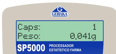
Após isso, pese aleatoriamente 10 cápsulas do lote que será avaliado e pressione ENTER para finalizar. Se durante o processo de captura for enviado um valor errado de peso, é possível apagar o registro, utilizando a SETA PARA ESQUERDA.
