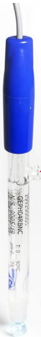
Orifício para preenchimento do eletrólito de referência, exclusivo para sensor tipo recarregável.
