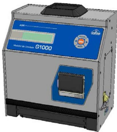
O G1000 dispõe de três instrumentos em um, gerenciados por um microprocessador interno de última geração. São esses três instrumentos: uma balança eletrônica, que mede o peso da amostra; um termômetro digital incorporado, que mede a temperatura da amostra dentro da câmara e a temperatura do G1000 e finalmente um Capacímetro, que indica o percentual de umidade para mais adiante sofrer as correções dos outros parâmetros.
