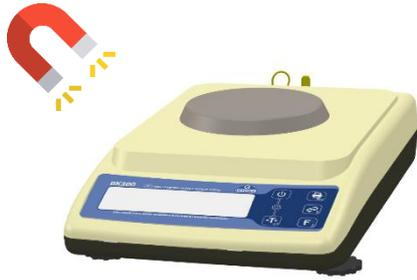
As balanças semi-analíticas utilizam um sensor com um conjunto magnético e os materiais magnéticos podem alterar esse campo e o valor do peso. Para esse efeito ser evitado, observe se ao redor da balança não existem ímãs próximos (como motores, por exemplo). Recomendamos que o material magnético fique o mais distante possível da balança.
