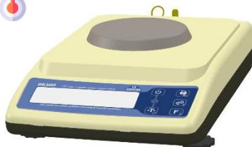
Evite instalar a balança em lugares que possuem incidência de sol ou fontes de calor, a mudança de temperatura causa a perda do ajuste pelo no gradiente térmico que a balança está submetida. Nunca direcione o ar-condicionado para o equipamento, pois ele gera vento sobre o prato, tornando a leitura instável. Em resumo, a variação de temperatura provoca a instabilidade térmica da balança.
