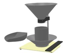
**Kit Peso Específico Café Verde e Torrado:** Kit específico para medição de densidade de Café Verde ou Torrado de acordo com a norma ISO.
