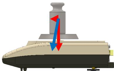
O ajuste errado do nivelamento da balança ocasiona uma pesagem errada devido ao efeito da decomposição de forças. Todos os modelos da linha BK deverão ser nivelados, utilizando o ajuste de nível, para um perfeito funcionamento, semelhante ao atingido na fábrica. Recomendamos a utilização de uma mesa estável e nivelada.
