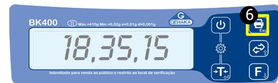
A balança possui uma bateria que mantém o relógio funcionando mesmo quando desligada da rede elétrica, com duração superior a 5 anos. Para verificar a integridade da bateria, desligue a balança da rede elétrica e observe se o relógio exibe "00:00:00". Caso contrário, entre em contato com a assistência técnica da Gehaka para substituição da bateria.
