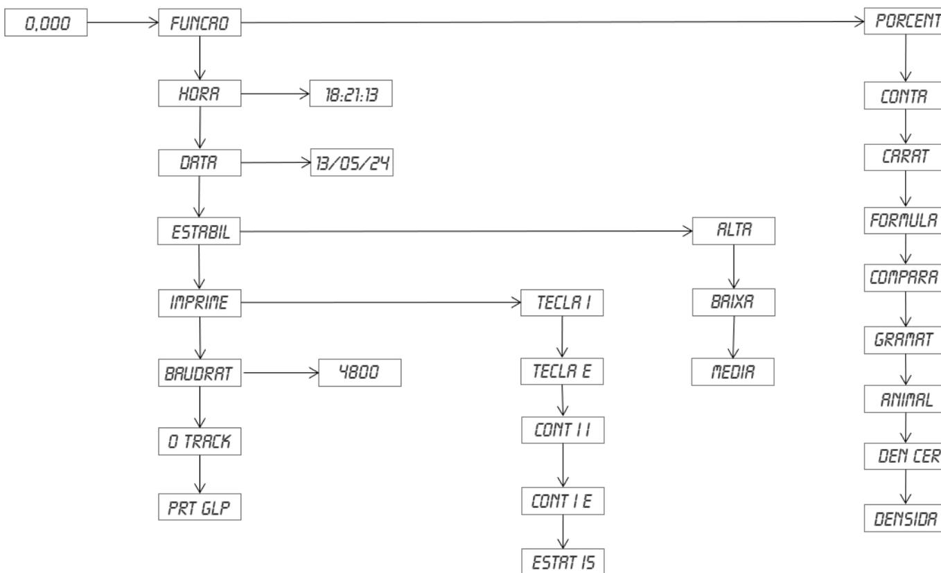
Para entrar no menu de configuração pressione a tecla [TARA] e, sem soltar, clique brevemente na tecla [LIGA/DESLIGA]. Ao soltar ambas as teclas você terá acesso ao menu de configuração, que será detalhado a seguir. Lembre-se, após entrar no menu de configuração, as teclas seguirão sua função secundária descrita anteriormente no item 6.
