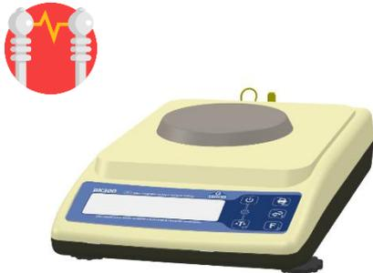
Evite o efeito das cargas eletrostáticas, pois elas irão atrair o prato ou o objeto que está sendo pesado, gerando um erro ou instabilidade na leitura. Observe com mais cuidado o efeito no inverno com ar seco. Para evitar esse efeito, recomendamos que o ambiente possua a umidade do ar acima de 45%.
