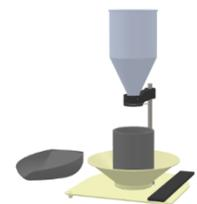
**Pesagem de Densidade (superior):** Dispositivo utilizado quando existe necessidade de pesar pequenos volumes de materiais.
