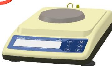
Não efetue a pesagem de substâncias quentes. O efeito de convecção do ar faz com que o ar quente arraste o objeto para cima e diminua o peso aparente. Para evitar o efeito, recomendamos deixar esfriar o objeto antes de iniciar a pesagem. A temperatura do objeto e da balança devem ser os mais próximos.
