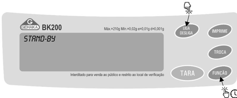
Para entrar no menu de configuração a balança deve estar no modo "STAND-BY". Com a balança aguardando pressione a tecla [FUNÇÃO] e, sem soltar, clique brevemente na tecla [LIGA/DESLIGA]. Ao soltar ambas as teclas você terá acesso ao menu de configuração. Lembre-se, após entrar no menu de configuração, as teclas seguirão sua função secundária descrita anteriormente.
